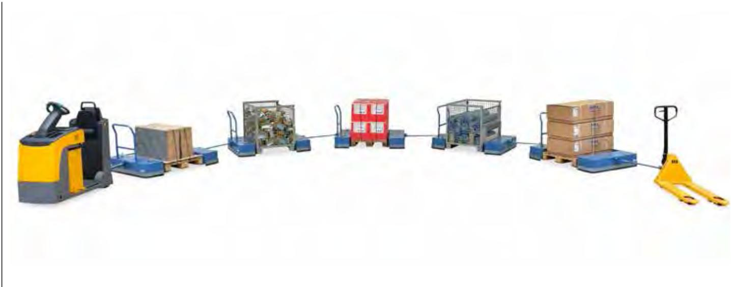
Routenzug mit Elektroschlepper und 5 Niederfler-Paletten-Fahrgestellen
