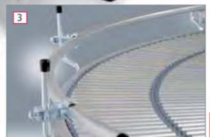
3 Seitenführungen aus Stahlrohr 25 mm Ø verzinkt. Stufenlos höhen- verstellbar von 50–130 mm. Breite stufenlos ver- stellbar von Bahn-Nutzbreite -140 bis +24 mm.
